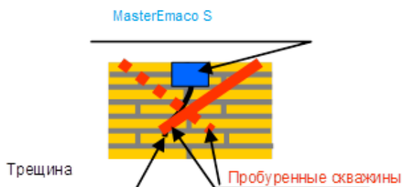
Рисунок 1 Примерная технология инъекции трещин.
